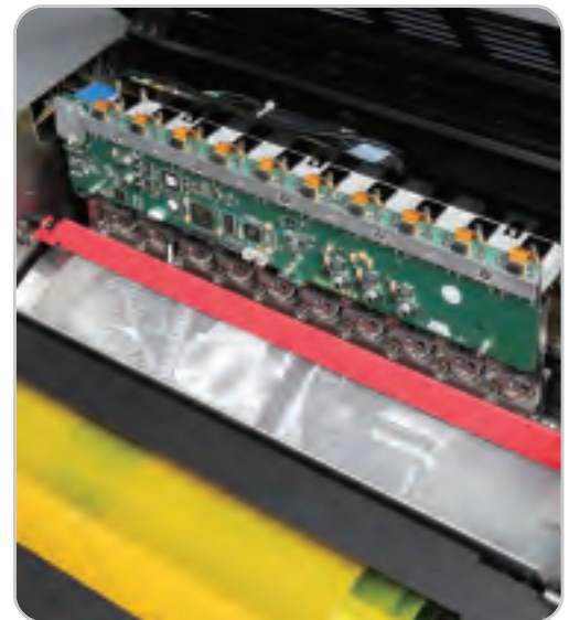
Die Presstek 52DI hat 10 Mehrstrahl-Laserdioden auf jedem ihrer Bebilderungsmodule.
